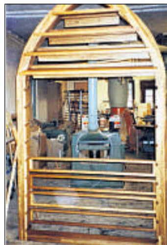
Ein ebenso reizvoller wie ungewöhnlicher Auftrag war für die Schreinerei Göhring, die Schallläden im Turm der Immenhäuser Kirche zu erneuern. Foto: nh
